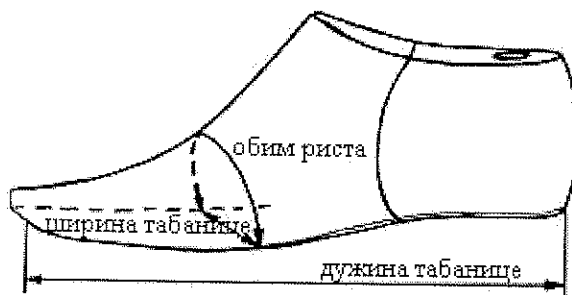
Слика 1 – Основне димензије калупа за ципеле
